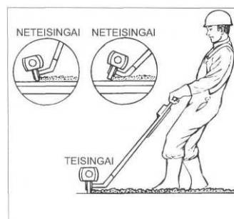
54 pav. Betono sutankinimas.
