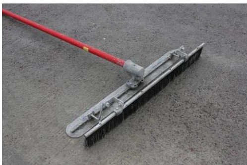
25 pav. Betono paviršiaus šluotavimo įrankis
