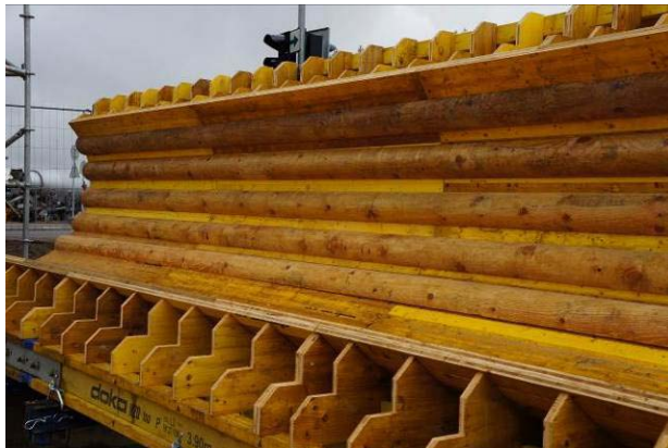
49 pav. Kolonos klojiniai: a) mediniai klojiniai sistemos TOP 50, b) klojiniai nuimti.
