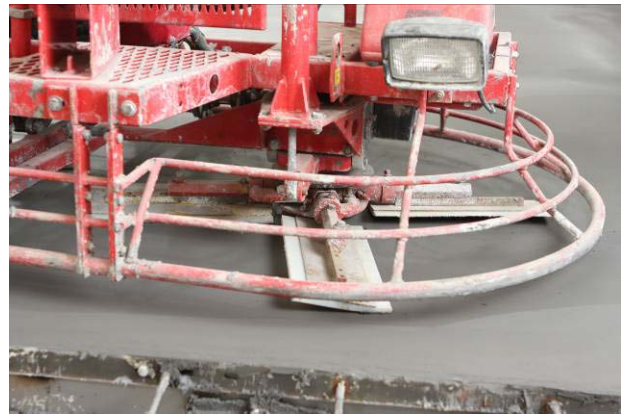
66 pav. Glaistymo mentės: plieninės, plastikinės
