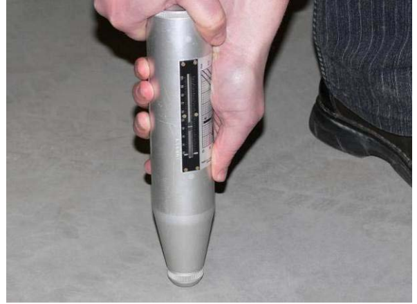
7 pav. Betono stiprio matavimas Šmito plaktuku
