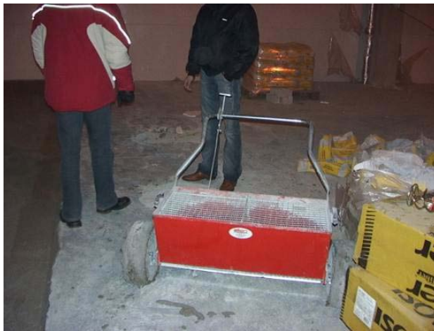
69 pav. Betonų paviršiaus kietiklio paskleidimo vežimėlis.
