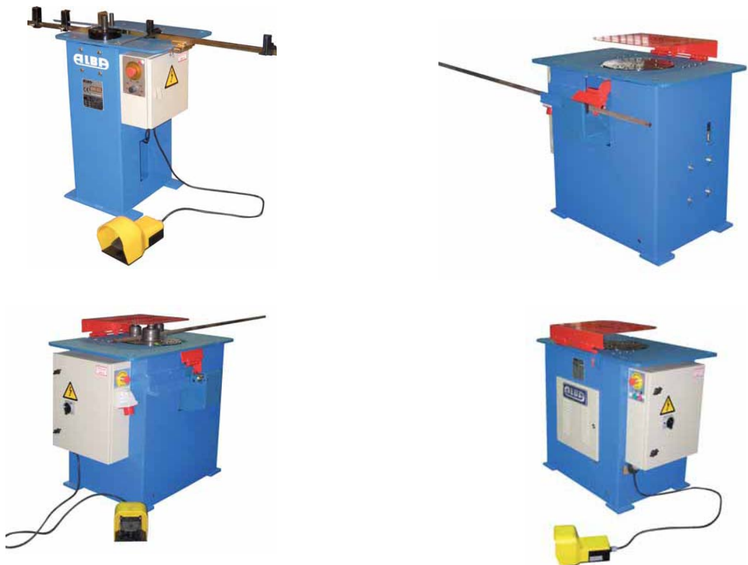
102 pav. Armatūros karpymo staklės.
