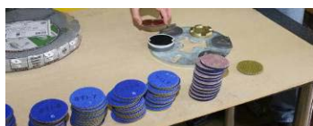
85 pav. Šlifavimo-poliravimo diskai.
