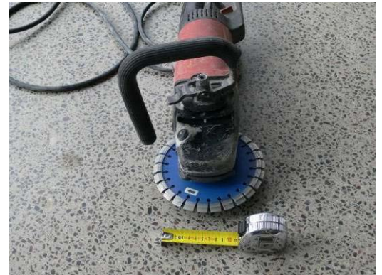
75 pav. Siūlės kampų nusklembimo įrankis.
