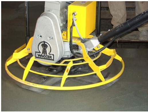
66 pav. Glaistymo mentės: plieninės, plastikinės
