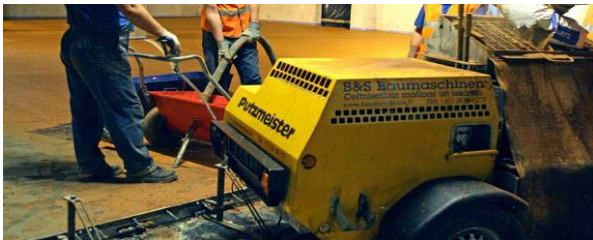
71. pav. Betono paviršiaus kietiklio maišymo įrenginys.
