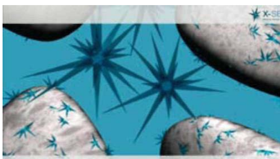
5 pav. X-SEED 100 yra susintetinti ypatingai smulkūs cemento hidratacijos produktai, kurie gali būti dedami į betoną tirpalo pavidalu.
