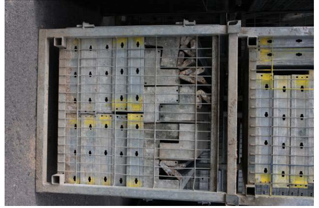
25 pav. Klojinių valymas ir sandėliavimas
